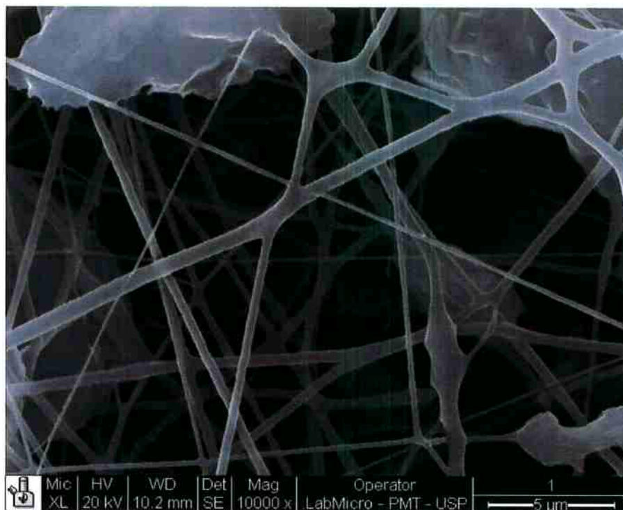
Figura 23 - Microscopia eletrônica de varredura da amostra A (solução contendo 10% de PHB e 0% de Acetato de zinco em clorofórmio) com 10000 x de aumento.
